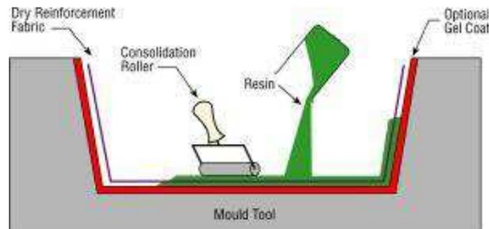
**Fig. 4:** Hand Lay Up Method
