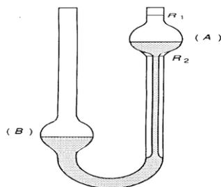
**Fig. 1:** Ostwald viscosimeter.
