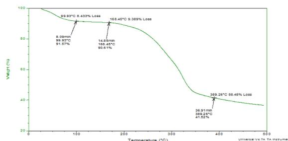
**Fig. 4:** TGA properties of UF resin.
