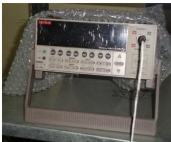
**Fig. 4-2:** Nanovoltmeter.
